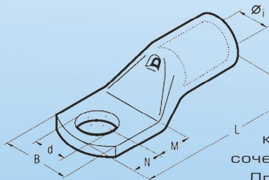
Наконечники «Prime-Flex» изготовлены из электролитической медной трубки. Специально разработанный участок «юбки» наконечника и контактной площадки отображают наилучшее сочетание механической прочности и электропроводности.
